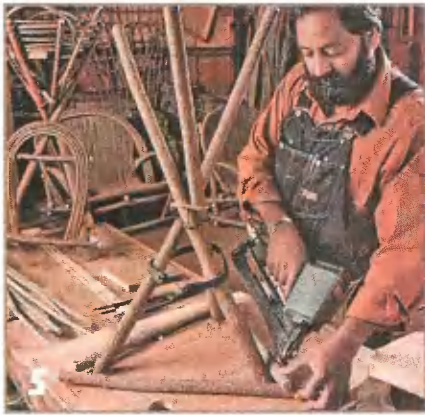
Во время сборки мастер фиксирует ножки на фанерном приспособлении.
