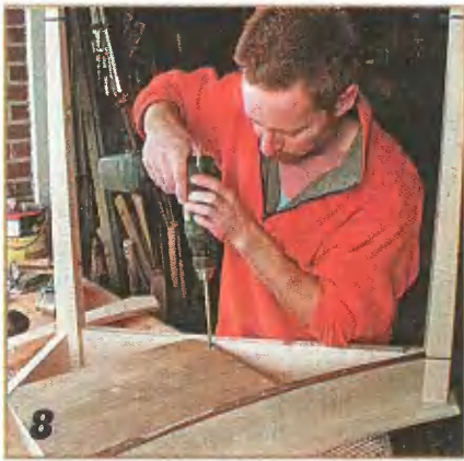
8 Нижняя панель служит опорой выдвигаемому ящику и придаёт конструкции жёсткость.
