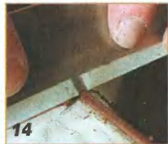
14 Самодельная «фильера». Чтобы сделать её, автор выпилил паз в скобеле. Фартук защищён липкой лентой.
