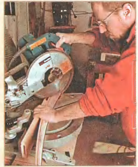
Выпиливание фасада ящика. Чтобы шов был менее заметен, распил делают под углом.
