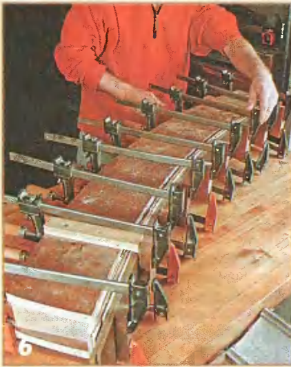
Для склеивания многослойной изогнутой царги понадобится много струбцин.
