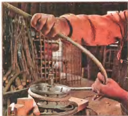
Формой для гибки прутьев может послужить и обод колеса.
