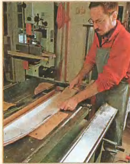
Опиливание передней царги по ширине.
