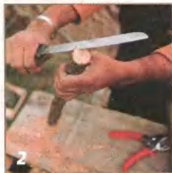
Ручная зачистка отпиленных концов заготовок предохраняет кору от растрескивания.
