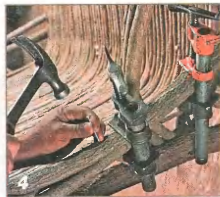
В свежесрезанной иве оцинкованные гвозди не ржавеют и не расшатываются.
