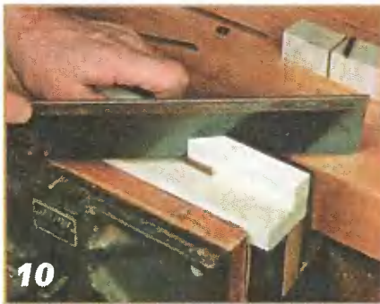
10 Мелкие детали вставок можно отпилить лобзиком или мелкозубой наградкой в тусле.
